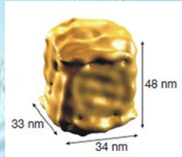
Трёхмерная реконструкция наношкатулки, собранной методом ДНК-оригами
